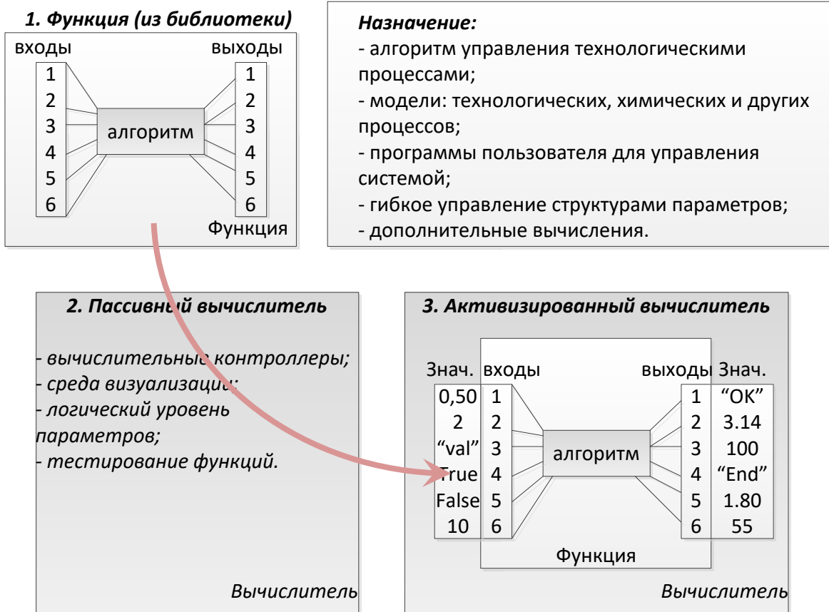
Рисунок 7. Основа среды программирования системы СКАДА
